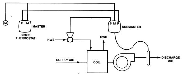
RESET CONTROL OF UNIT DISCHARGE TEMPERATURE FIGURE 3-12
