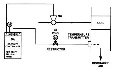
SINGLE INPUT RECEIVER CONTROLLER APPLICATION FIGURE 3-17
